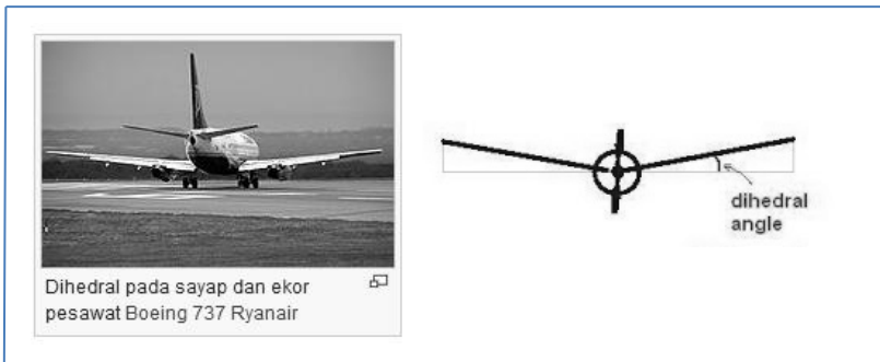
Gambar 3.7 Sudut Dihedral Pada Pesawat terbang
